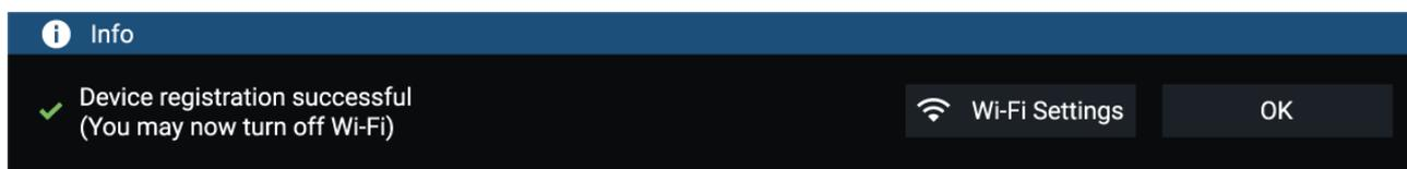
Al termine della registrazione, se lo si desidera, è possibile disattivare la connessione Wi-Fi selezionando Impostazioni Wi-Fi e spegnendo il Wi-Fi dell'MFD. Selezionando OK si chiuderà la casella informazioni mantenendo accesa la connessione Wi-Fi.
