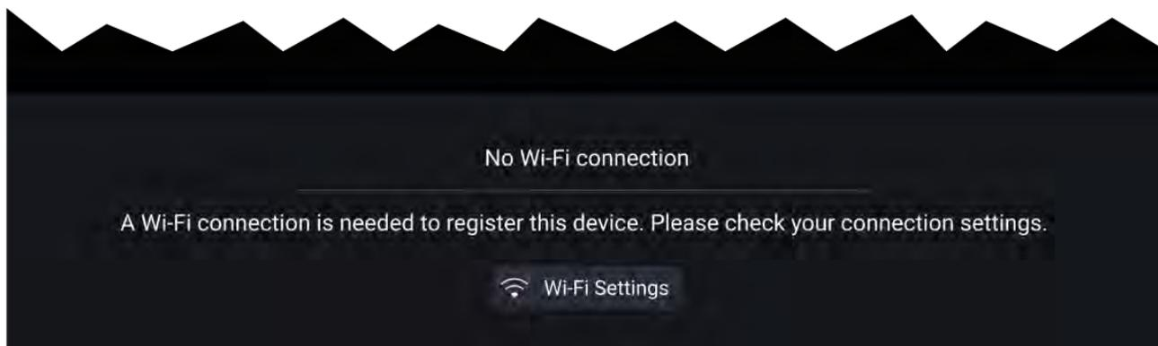
La prima volta che si apre l'app UAV, dopo un factory reset dell'MFD, o dopo aver aggiornato il software MFD, l'app UAV deve essere registrato utilizzando una connessione Internet sull'MFD. Selezionare Impostazioni Wi-Fi per creare una connessione a Internet.
