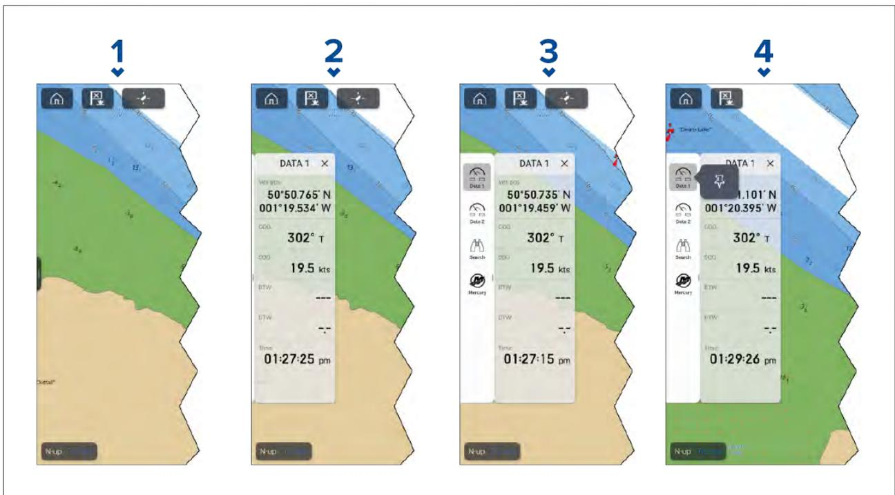
1. Scorrendo brevemente da sinistra a destra sul comando della barra laterale a sinistra dello schermo verrà visualizzata la barra laterale. Scorrendo più a lungo verrà visualizzata la barra laterale e il selettore della barra laterale
