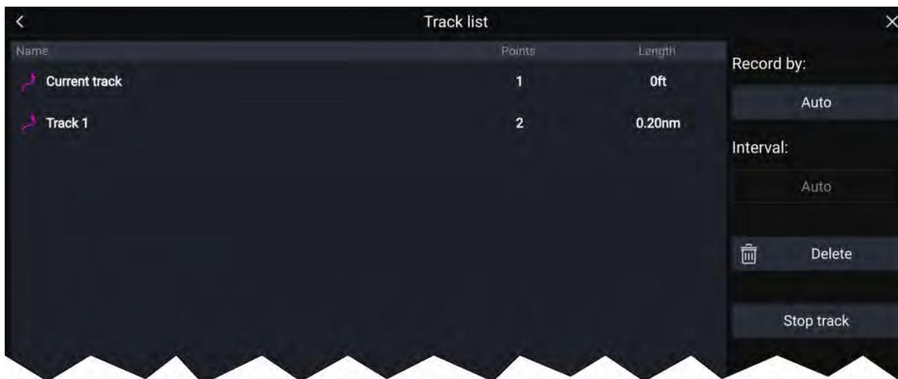
Dall'elenco delle tracce è possibile avviare o interrompere la registrazione delle tracce, eliminare una traccia o scegliere la modalità di registrazione delle tracce.
