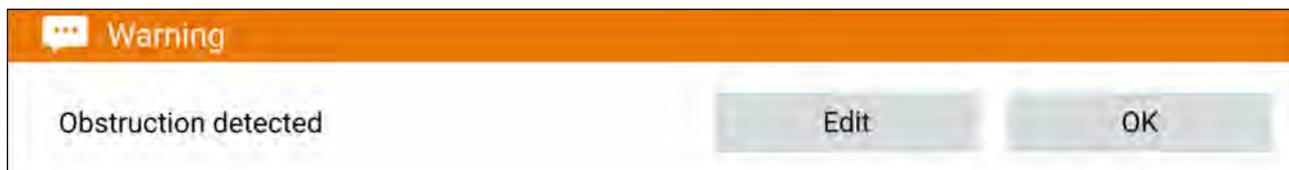
Quando viene attivato l'allarme Ostruzioni, viene visualizzata una notifica di allarme e viene emesso un segnale acustico sull'MFD. Dalla notifica sullo schermo è possibile riconoscere l'allarme selezionando OK o modificare i parametri dell'allarme selezionando Modifica.
