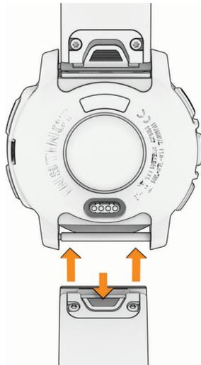
**NOTA:** verificare che il cinturino sia fissato. Il fermo dovrà essere fissato al perno dell'orologio.
