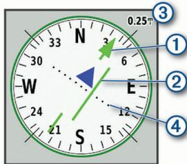
L'indicatore di percorso ① indica la posizione in relazione a una linea di percorso che conduce alla destinazione. L'indicatore di deviazione (CDI) ② fornisce l'indicazione di deviazione (destra o sinistra) dal percorso. La scala ③ si riferisce alla distanza tra i punti ④ sull'indicatore di deviazione, che indica la distanza dal percorso.
